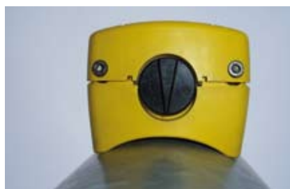
Taster von unten. Der Pfeil zeigt die Querungsrichtung.
