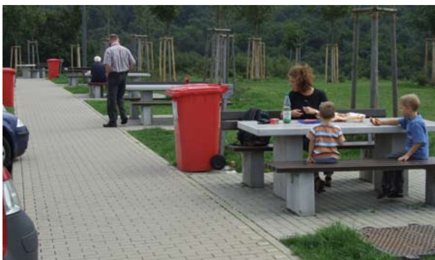
Die Tische sind an den Kopfenden für Rollstuhlfahrer unterfahrbar.
