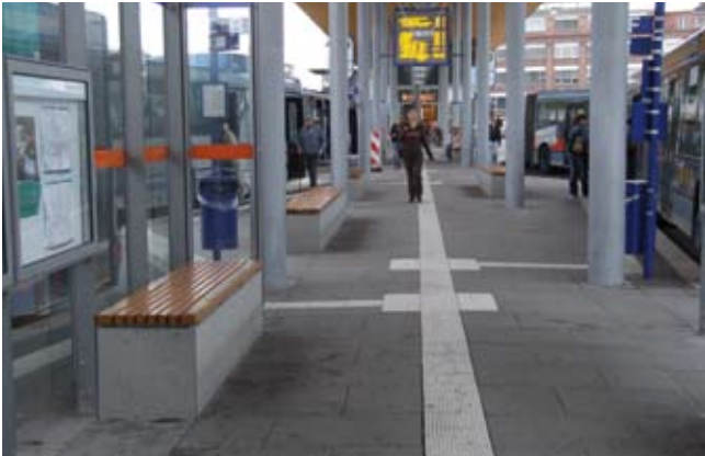
Auf der zentralen Leitlinie markieren quadratische Aufmerksamkeitsfelder die Abzweige zu den Einstiegsstellen.
