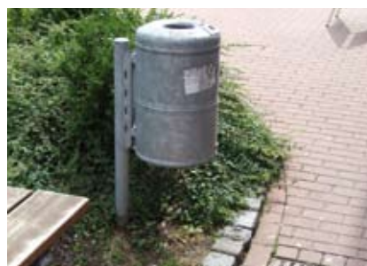
Klare Führung durch Rasenkante für Stockgeher, vorbildliche Anordnung des Papierkorbs hinter der Kante.
