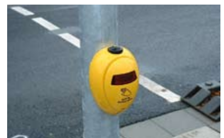
Vibrationstaster auf Oberseite.
